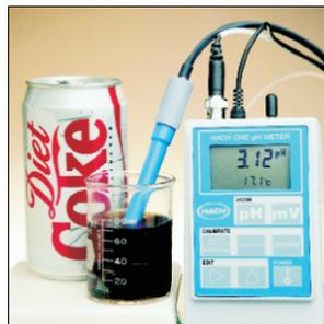
Figura 7 - Medida de pH da coca através de um PHmetro
