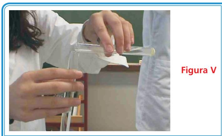
**VII** - Lavagem do precipitado : A lavagem do precipitado é feita com água destilada.
