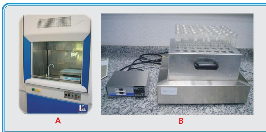
Figura 15: Capela de exaustão de gases (A) e bloco digestor (B)
