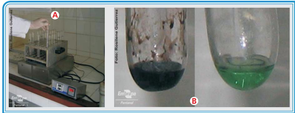
**Figura 19: Bloco digestor para análise de N total (a) e a coloração da solução digestora (sulfúrica) antes e depois da digestão (b).** Fonte: Embrapa Pantanal, 2006
