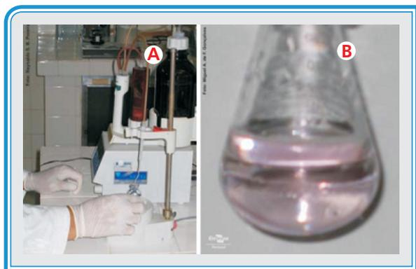
**Figura 21. (A) Titulação para a determinação da dosagem de nitrogênio. (B) Viragem na titulação para a determinação da dosagem de nitrogênio total.**
