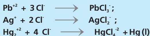
não reduza a concentração de cátions a um valor tal, que a precipitação seja incompleta ou não ocorra de modo algum:  $[\text{Pb}^{+2}][\text{Cl}^-]^2 < K_{ps}$ .
