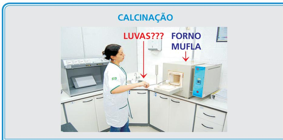
Figura 14: calcinação de material orgânico em mufla elétrica
