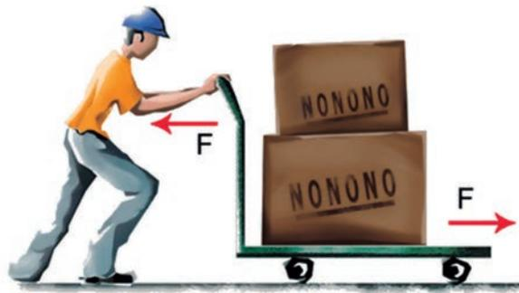
**Figura 6.2: Ação e reação no ato de empurrar uma mala**
