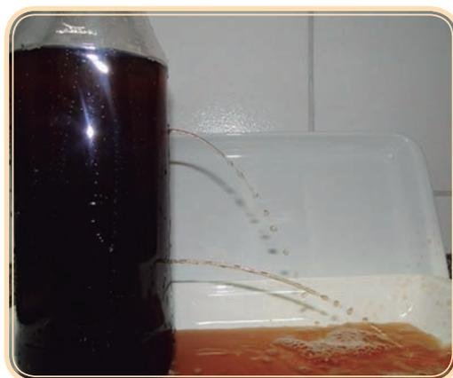
**Figura 9.2: O alcance diferente para água que sai de furos de alturas diferentes**
