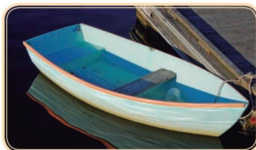
**Figura 9.7: A parte da frente do barco possui menor área para facilitar a navegação.**
